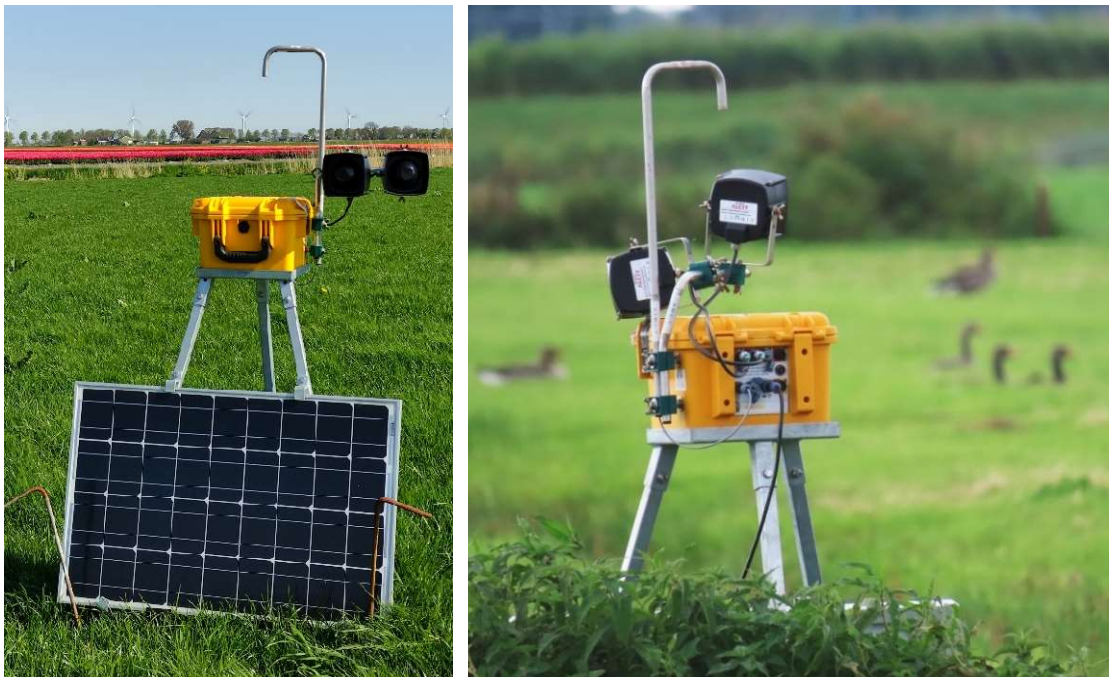
Figuur 2.1: Voorkant en achterkant van een BirdAlert opstelling met een box op een onderstel, met aangesloten microfoon, luidsprekers en zonnepaneel.
