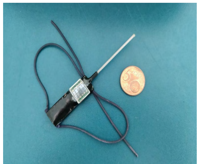
Figuur 2. Pathtrack nanoFix GEO RF zender met zonnepaneel, voorzien van een tuigje van elastiek. Deze wordt op de juist lengte vastgezet door middel van dubbele knoopjes icm secondelijm. Pathtrack nanoFix GEO RF with solar panel and leg-loop harness. The harness will be secured with two knot and glue.
