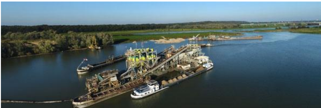
Foto 2 Voorbeeld natte grondstofwinning middels drijvende zandklasseerinstallatie
